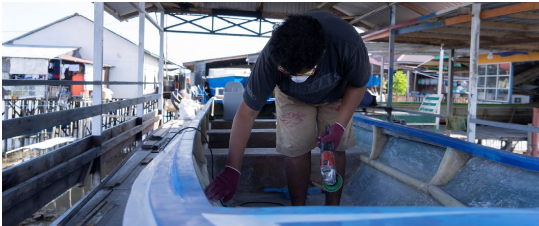
Gambar 62. Proses pembuatan perahu fiber oleh Tanjung Mamat Fiberglass
